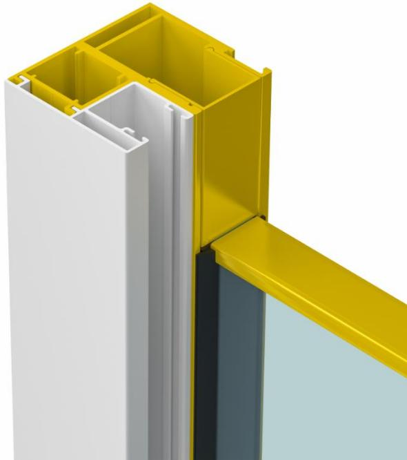
**Bild 3:** Die 16 mm starke und windwiderstandsfähige VSG-Glasscheibe wird hinter dem Rollladenbehang in eine zusätzliche Nut der Führungsschiene eingesetzt und befestigt. Die Alukon Absturzsicherung ist bei geschlossenem Rollladen von außen nicht sichtbar und sorgt so für eine einheitliche Ansicht der Außenfassade.
